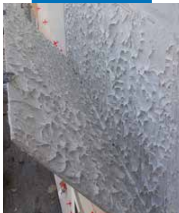
Utmärkt vätning mellan underlaget och plattans baksida
