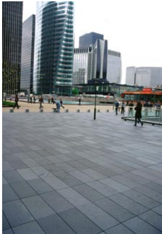
Fig 4.10 Rektangulära skifferplattor med klovyta i bestämda format på gångyta.
