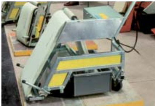
Fig 4.53 Maskin för upptagning av bruk och rengöring efter fogning.
